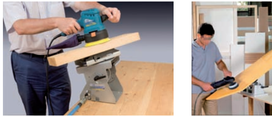
Figura 40. Sistemas de sujeción por vacío para piezas.
