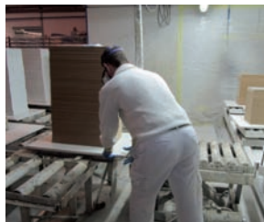
Figura 61. Sistema de transporte de piezas con rodillos.
