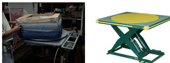
Figura 83. Mesa de trabajo con plataforma giratoria.
