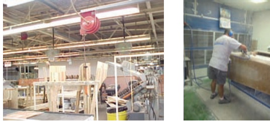
Figura 48. Sistema de enrollado superior para herramienta neumática.
