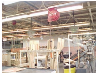
Figura 89. Sistema de enrollado superior para herramienta neumática.
