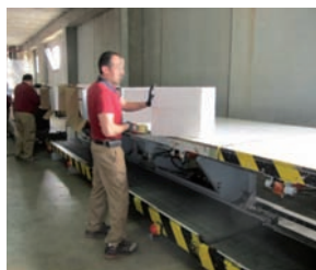
Figura 134. Cinta transportadora con sistema de elevación y volteo.
